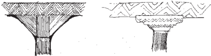
Aussteifung in einem Winkel von 45 Grad
