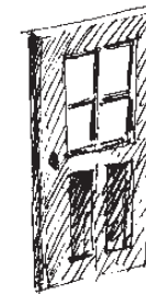
solide und verglast
